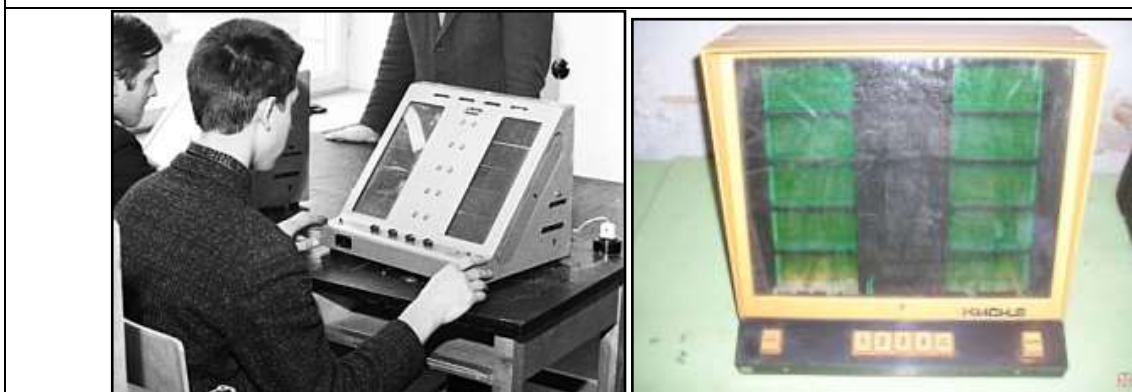
Рисунок 1. Электромеханические устройства для обучения и контроля знаний: К-53 "Ласточка" (слева), КИСИ-5 (справа)
